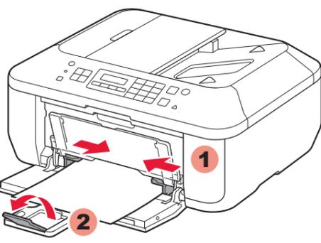
4 调整纸张导片以适合所用纸张的宽度，然后打开出纸托盘扩展架。
