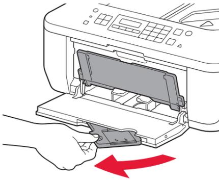
1 确认出纸托盘已关闭，然后拉出靠纸架。
