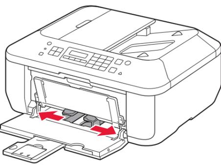
2 将右侧纸张导片滑至最右端。左侧纸张导片与右导片同时移动。
